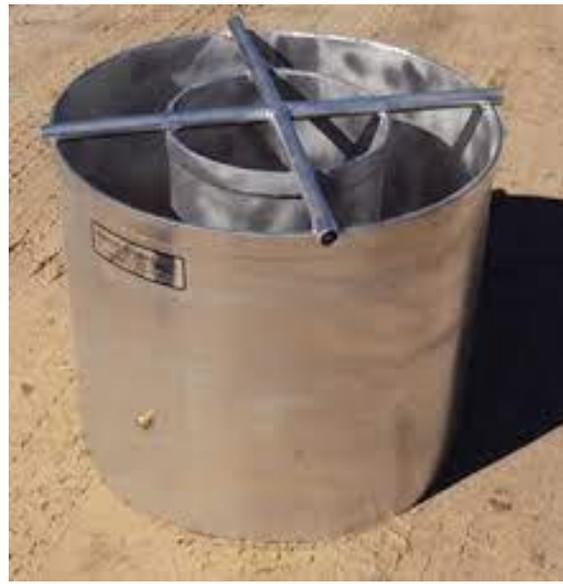
Mede a taxa de decaimento da coluna d'água no anel interno
