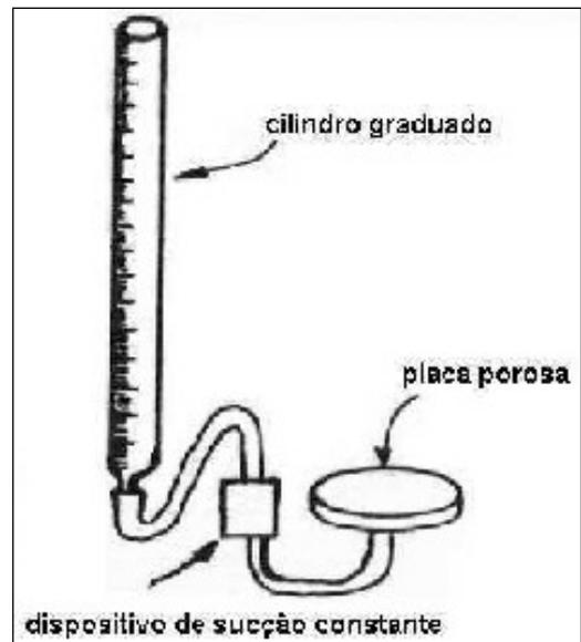
Figura 5.2: Atmômetro Fonte; Ahrens, C.D. (1994)
