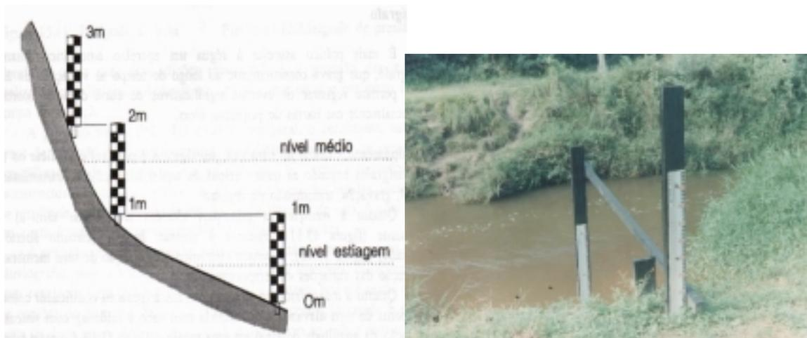
Figura 20 – Esquema de instalação e réguas na margem do rio
